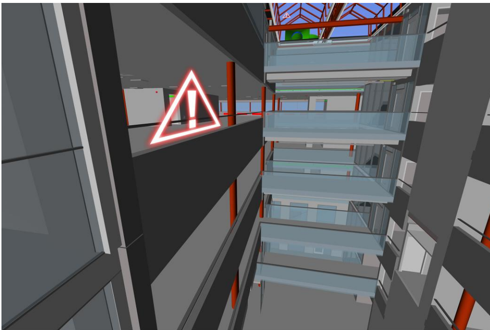
Figur 12 Varningstriangel vid balustrad, ytan föreslås istället för rak
